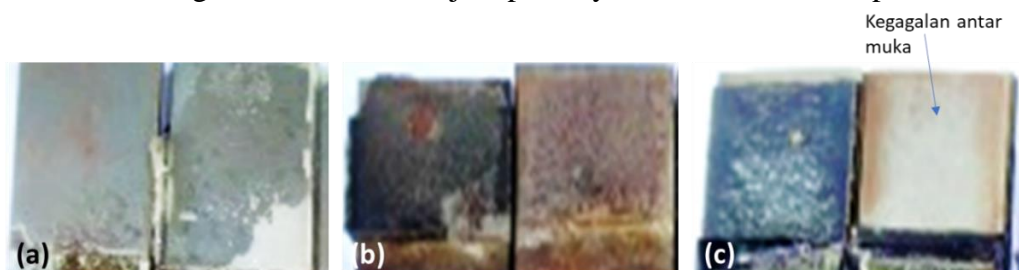
Gambar 6. Kegagalan sambungan untuk perekat (a) tanpa filler , dan dengan filler partikel karet (b) 5% dan (c) 10%.
