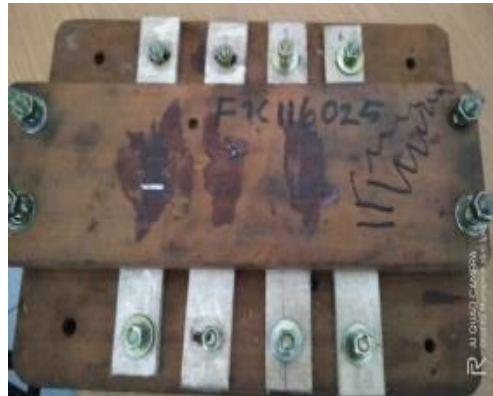
Gambar 2. Jig dan fixture sambungan.
